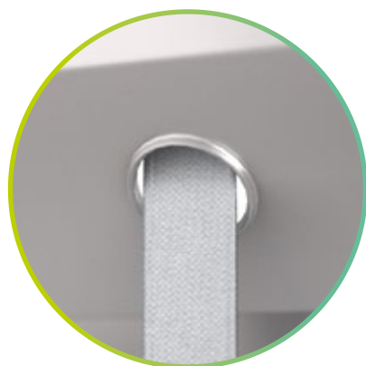
1 Découpes serties. Les découpes serties permettent que le Texband ne soit pas cisailé sur les rebords et prolongent ainsi la longévité du produit.
